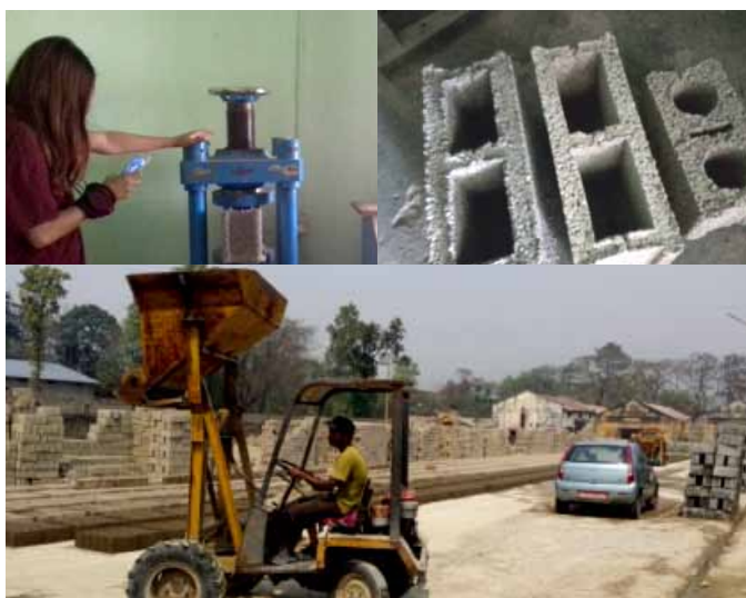
Fabricació de blocs d'Awasuka i proves de càrrega, comparant entre blocs locals i blocs d'Awaskua.
