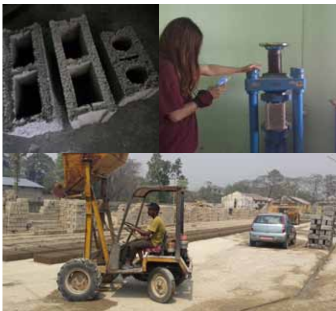
Fabricació dels "blocs Awaskua" i proves de resistència comparant entre blocs locals i blocs Awaskua.
